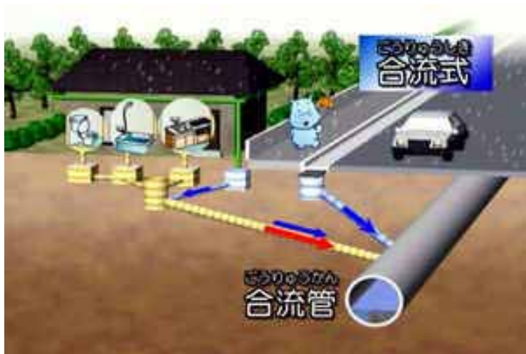
汚水と雨水を同じ管で流す
