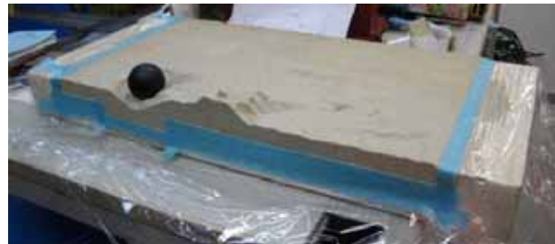
図 7 河床模型 (t=9min)
